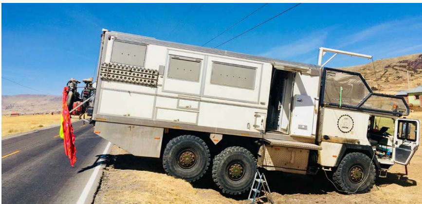
Ideale Position zum Wechseln des mittleren Reifens
